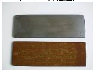
屋外暴露防錆試験 (180日経過)
