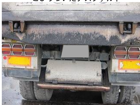
こびりついたアスファルト
